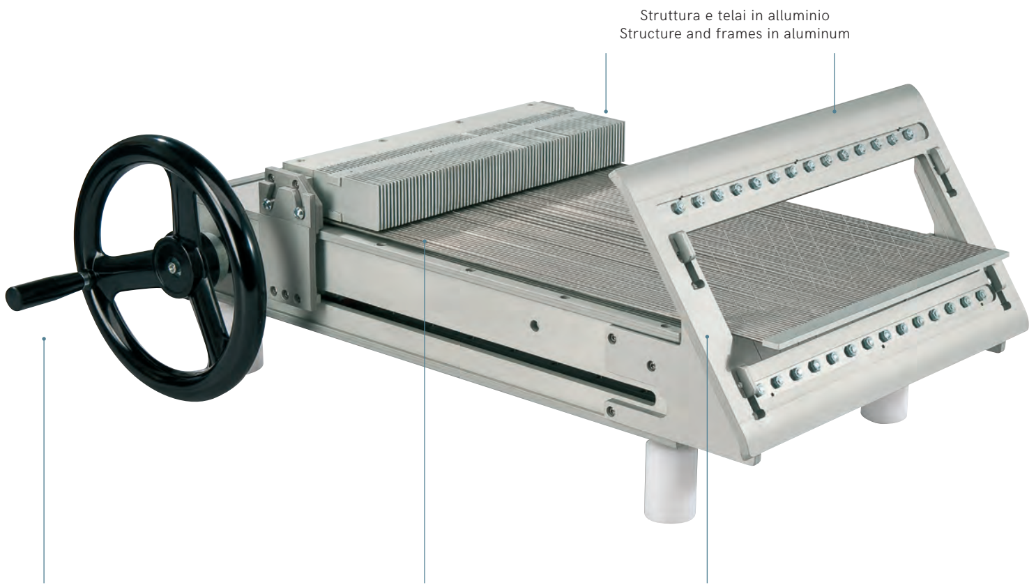
Manopola di avanzamento grande per permettere un taglio più preciso e delicato
